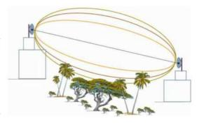
Wie weit über dem Boden und anderen Hindernissen die Antennen sein müssen, wird durch den Durchmesser der Fresnel-Zone bestimmt. Der Durchmesser der Fresnel-Zone hängt von der Frequenz und den Abständen zwischen den beiden Sendern ab.
