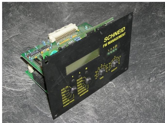
**Bei EPROM-Versionen kleiner als FW9.20, muss nach dem Tausch das Regelgerät auf „Werkseinstellung“ gesetzt werden.
