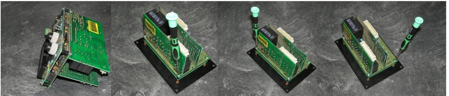
Die Display-Platine kann jetzt wieder auf das Elektronikteil vorsichtig und gleichmäßig aufgesteckt werden.
