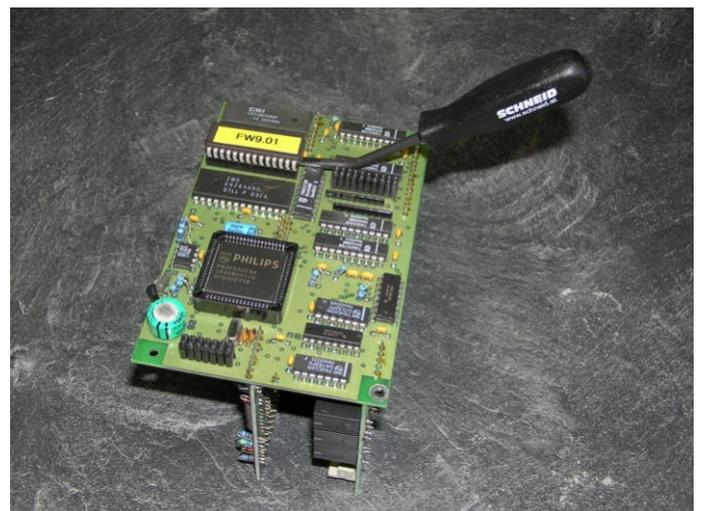
Die drei Schrauben sind zu entfernen und die Display-Platine vom Elektronikteil vorsichtig und gleichmäßig abzuziehen. Es muss darauf geachtet werden, die drei schwarzen Distanzhülsen nicht zu verlieren.
