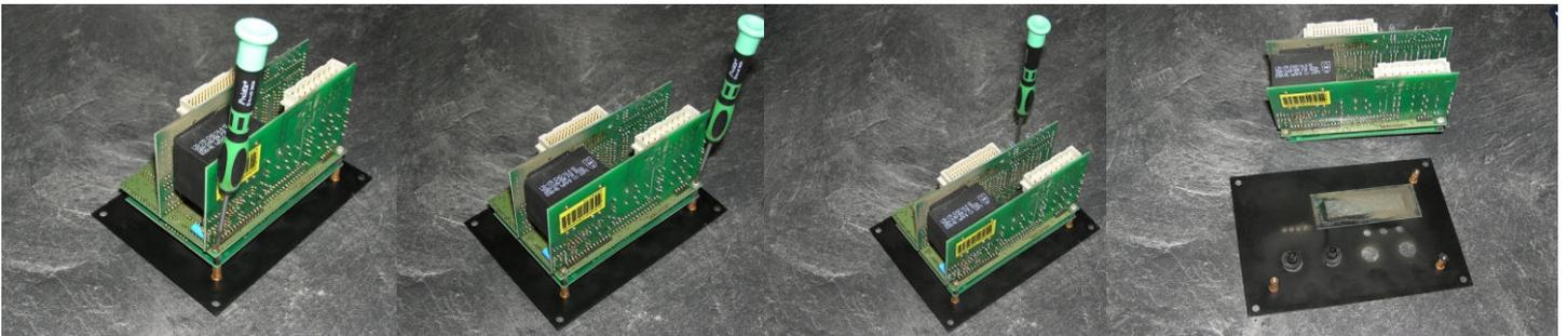
Nach dem Lösen der drei Schrauben, kann die Frontplatte vom Elektronikteil getrennt werden
